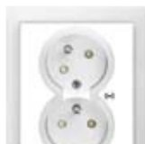
zásuvka dvojnásobná s natočenou vrchní dutinou, s clonkami, s ochranou před přepětím, s akustickou signalizací poruchy
